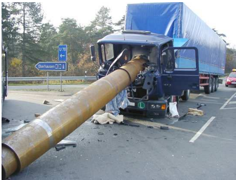
Joonis 1: Järsu pidurdamise ajal tungisid halvasti kinnitatud terastorud läbi koormavõre ja juhikabiini.
