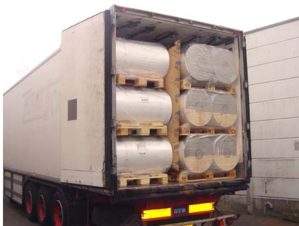
Joonis 18: Täitematerjal lastiridade vahel
