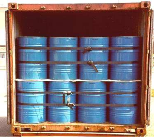
Joonis 89: Konteineris kahes reas virnastatud vaadid, kaks neljarealist kihti
