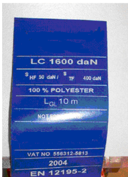
Joonis 38: Standardile EN12195-2 vastav markeering
