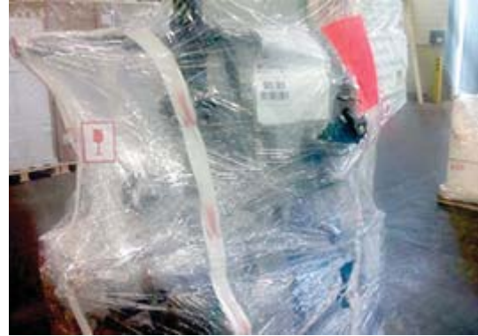
Pakkaamaton kone lastattu EUR-lavalle. Painopiste ylhäällä, kaatuu helposti. Lisäksi erilaisia venttiileitä tulee lavan ulkopuolelle.
